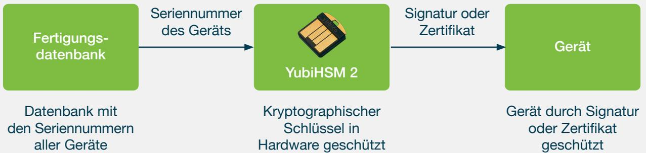
Die obige *Abb. 1* zeigt eine High-Level- Übersicht über die vorgeschlagene Lösung auf Basis des YubiHSM 2, die als Ersatz für eine vorhandene Lösung oder als ganz neuer Prozess in Fabriken und/oder Fertigungsstraßen implementiert werden könnte. Das Wichtigste dabei: Der kryptographische Schlüssel, der zum Signieren und/oder Zertifizieren von Komponenten verwendet wird, *verlässt niemals* die YubiHSM 2-Hardware. Dies gewährleistet ein hohes Maß an Sicherheit.
